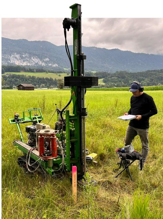
Rammsondierung im Bereich des geplanten Dammverlaufs
